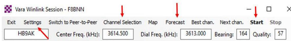
**Si le message ne part pas, vérifier la concordance des modes de transmission entre le Message et Winlink Session : les 2 doivent être soit en VARA HF Winlink soit en VARA Peer to Peer**
