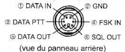
La sortie BF est la pin 5 ( ce câblage correspond en FM à la sortie 1200 bds), il est donc utilisable en FM mais avec des performances inférieures en particulier avec VARA FM
