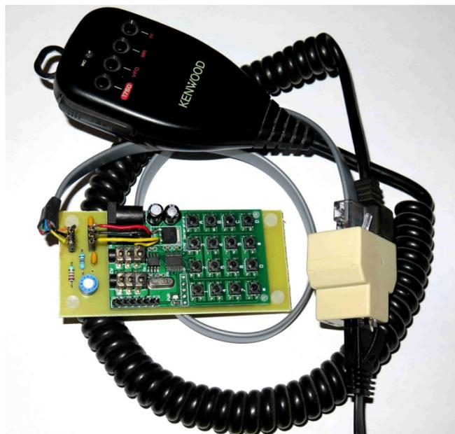
*Photo 6 : Le montage complet avec le micro et le générateur DTMF en parallèle*
