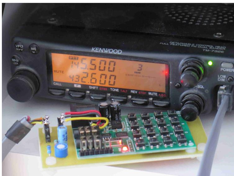
Photo 7 : Pilotage direct d'un Kenwood TM-732 par le clavier DTMF
