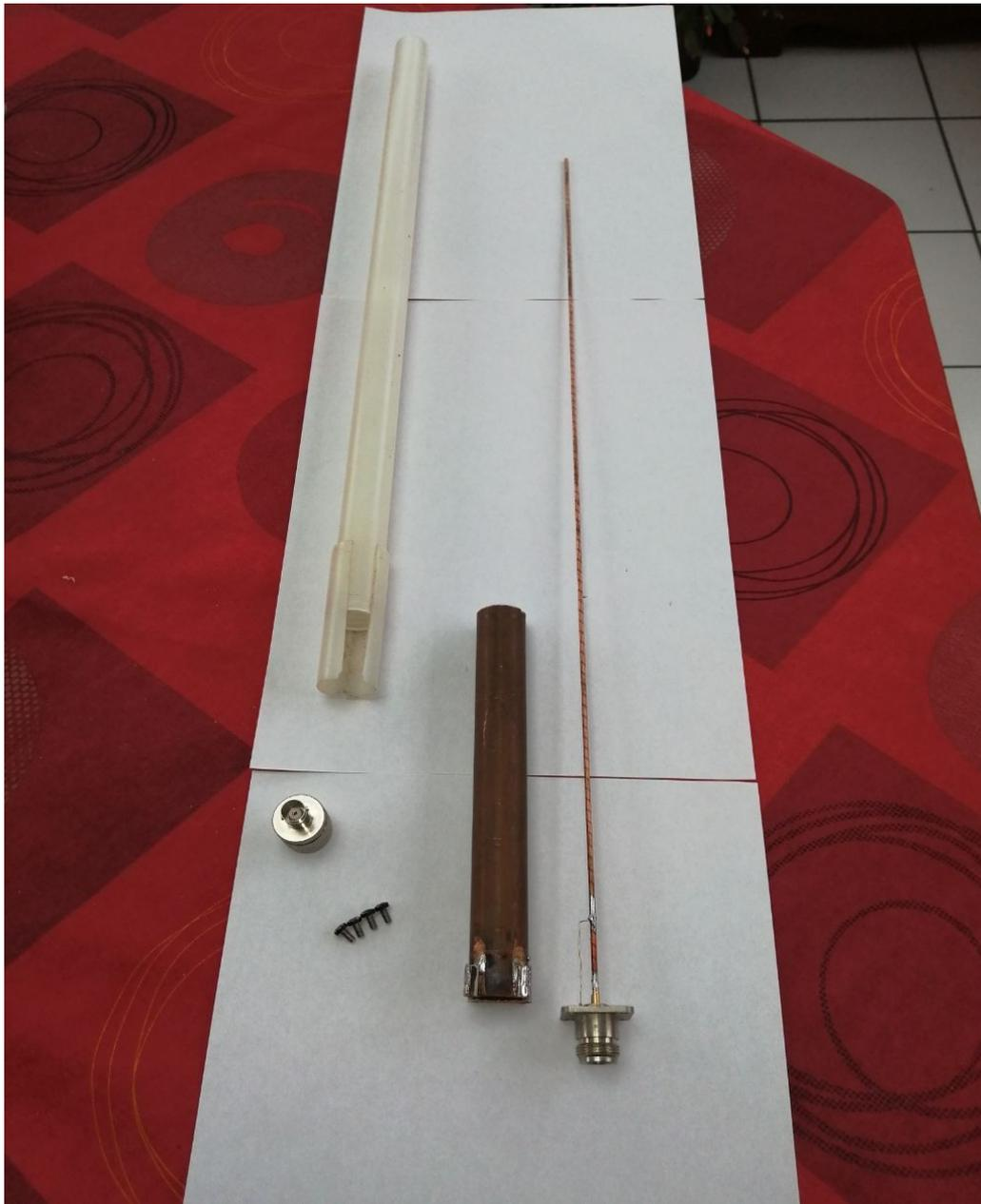
Voici l'antenne en vue éclatée, on trouve les 4 vis, le quart d'onde en tube de Cu de 20/22, la fiche N avec l'antenne et son gamma, il manque le chapeau en téflon qui centrera l'antenne au milieu du quart d'onde,
