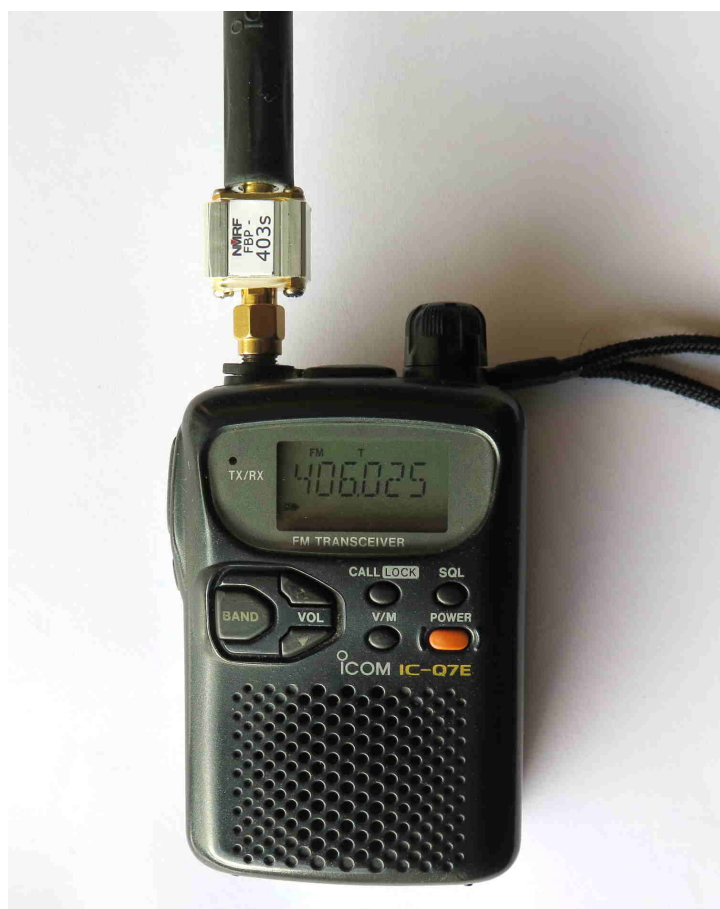
Photo 1 : Filtre « FBP - 403s » utilisé avec un IC-Q7. Le filtre est inséré entre l'antenne et le TX.
